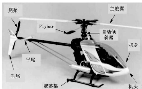
图 4 无人机结构
