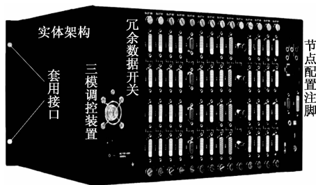
图 2 航天器 FPGA 配置单元的 CPLD+存储器
