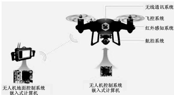
图 4 无人机控制系统结构图
