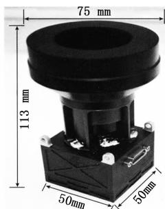
图 1 星敏感器外观结构图
