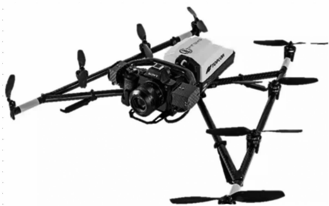
图 1 拓普康猎鹰 8 号八旋翼无人机结构
