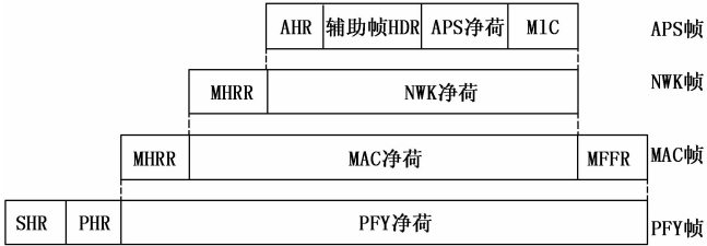
图 10 ZigBee 数据包格式
