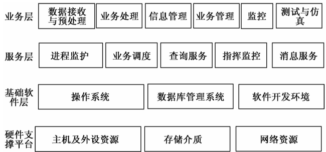
图 3 应急指挥监控系统软件各层次逻辑结构
