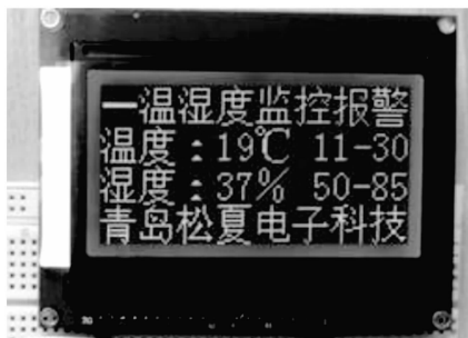
图 8 12864LCD 显示当前住宅区的温湿度信息
