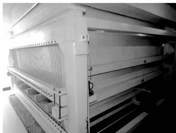
图 5 蒸渗仪地下室称体部分
