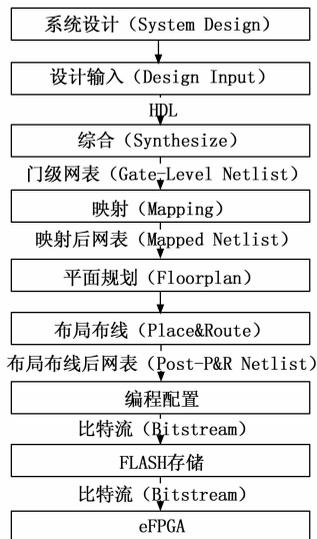
图 3 eFPGA 逻辑重构流程
