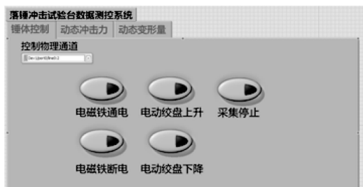
图 5 落锤冲击试验台测控系统界面
