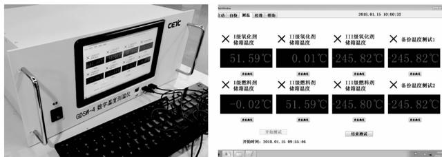
图 6 推进剂测温设备及操作界面
