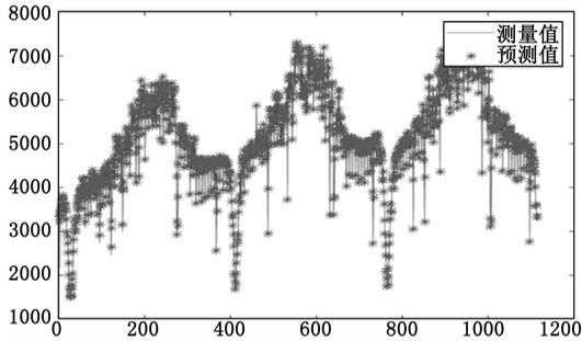
图 7 经卡尔曼滤波后输出的预测值与测量值
