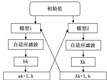
图 2 自适应滤波流程图
