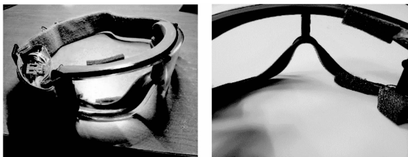
图 3 护目镜示意图及眼电采集的电极位置
