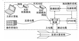
图 1 某型火箭地面测控系统组成示意图
