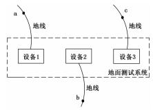
图 6 地信号电压波动原理示意图
