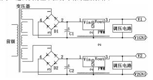
图 2 地面测控系统的供电电路原理示意图
