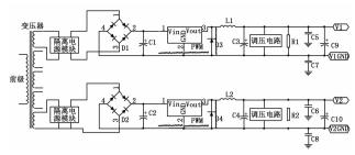
图 5 地面测控系统的供电电路原理示意图 (电磁兼容改进设计后)
