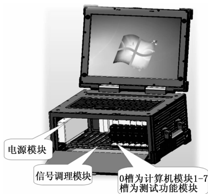
图 2 综合检测控制台内部结构示意图
