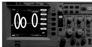
图 5 雷达工作在任意频点时 Q 路输出波形
