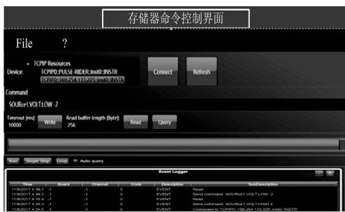
图 3 存储器命令控制界面
