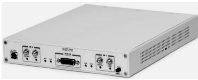
图 2 USRP RIO 软件无线电平台硬件实物图
