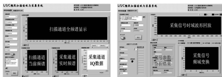
图 5 小型双通道电子侦察系统上位机软件界面设计
