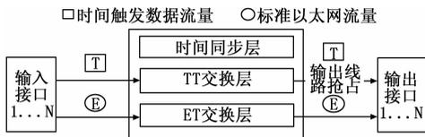
图2 交换机基础结构示意图
