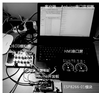
图 6 OBDII 模拟器仿真试验平台
