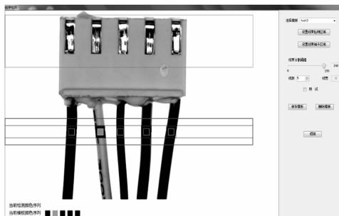
图 2 线序检测软件模板设置界
