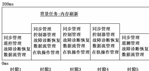
图 6 星载核心控制软件的动态结构
