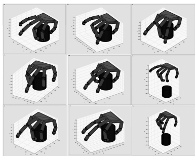
图 18 力封闭抓取圆柱体结果图（丢失 2 个摩擦接触点）
