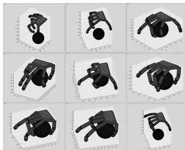
图 15 力封闭抓取球体结果图 (丢失 2 个摩擦接触点)
