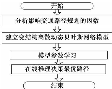
图 1 最优路径规划方法的简单流程
