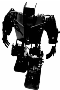
图 14 小型仿人双足机器人组装实体样机
