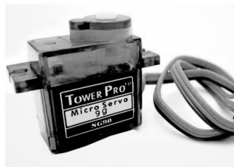
图 6 SG90 舵机外观图
