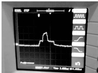
图 6 经过细分后进入线圈的脉冲波形图
