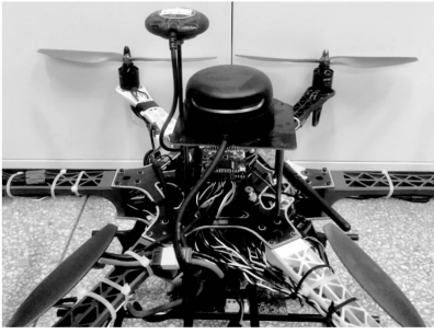
图 1 搭载激光雷达的实验平台
