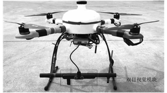
图 8 多旋翼无人机系统
