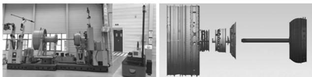
图 3 基于数字孪生的航空发动机低压涡轮单元体真实、虚拟对接并行过程展示
