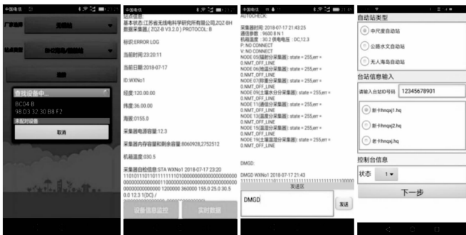
(a) 站点选择测试 (b) 设备监测 (c) 串口终端 (d) DTU 设置
