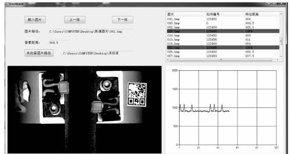
图 10 系统采集扣件图像实例
