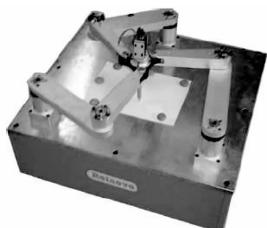
图 8 运行中的三自由度冗余驱动并联机器人
