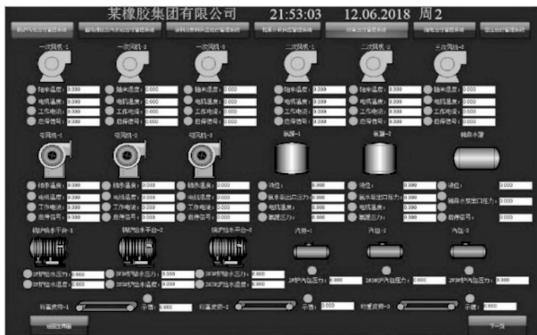
图 6 锅炉汽机运行管理系统—汽机部分
