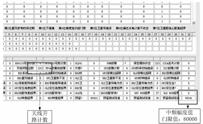
图 5 中频幅度天线开路检测
