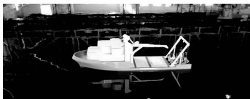
图 3 试验用船舶模型
