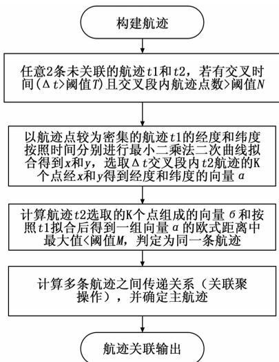
图 3 航迹关联流程
