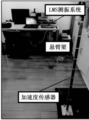
图 4 悬臂梁加速度计实验装置
