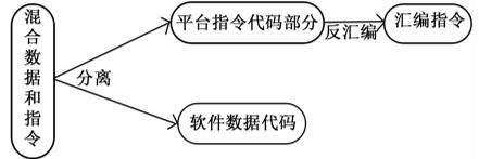
图 3 关联缺陷检测技术反汇编流程图
