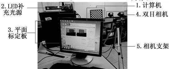
图 4 双目视觉测量实验平台
