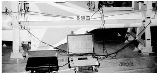
图 6 某型舰载装备振动监测图
