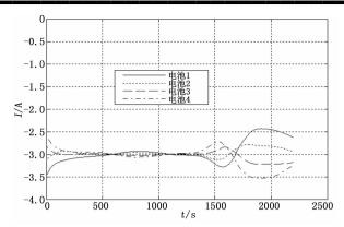
电池1、电池2、电池3与电池4的放电电流 (1C速率: -12A)
