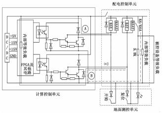
图 4 某航天器电气系统潜通路问题原理图
