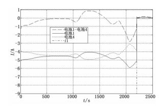
图 6 电池 1 与电池 2 的放电电流 (1.5C 速率: -9 A)
