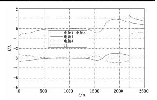
图 5 电池 1 与电池 4 的放电电流 (1C 谏率: -6 A)
