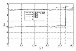
图 4 电池 1 与电池 2 的放电电流 (1C 谏率: -6 A)
