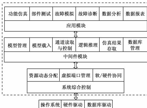
图 9 系统软件功能结构图
