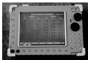
图 7 显控终端外形及人机交互界面
