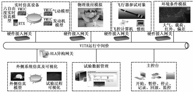
图 8 基于 VITA 的系统级联合虚拟试验
