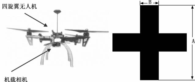
图 2 无人机结构与机载相机安装方式 图 3 目的地十字标识
