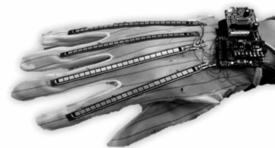
图 1 手势手套系统内部结构
