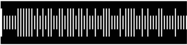
图 2 插入周期的最大长度序列靶标
