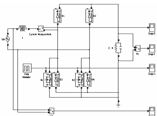
图 4 主电路 MATLAB 仿真原理图
