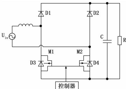
图 1 Boost 拓扑桥式 PFC 整流电路
