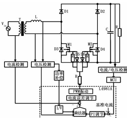
图 7 系统控制电路框图
