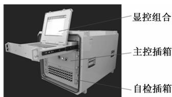
图 2 筒弹测试故障模拟器硬件示意图
